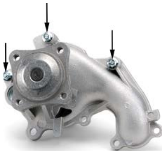
Foto 2: Zmienione położenie gniazd montażowych
